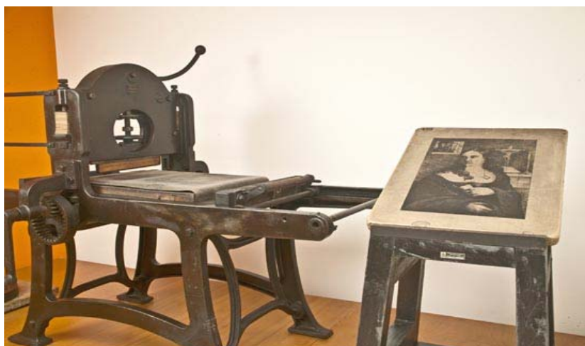
Prensa litográfica en la que se reprodujeron billetes, estampillas y otros títulos valores (imagen tomada de la web de la Imprenta Nacional de Colombia)
