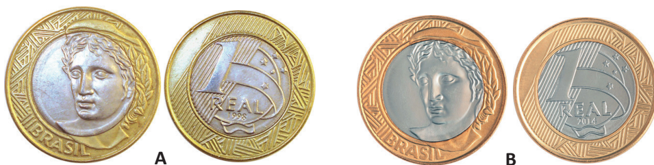
Figura 2. Moedas de R$ 1,00: (A) de 1998 a 2001, de cuproníquel (núcleo) e Alpaca (anel); (B) a partir de 2002, de aço inoxidável (núcleo) e aço inoxidável revestido de bronze (anel). Imagens: (A) Coleção Eduardo Rezende (B) Tacio Philip ( www.moedasdobrasil.com.br )
