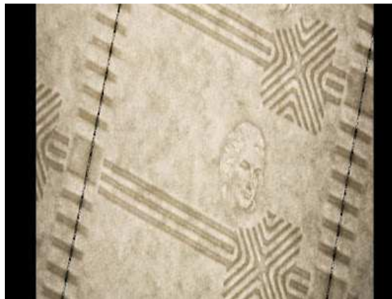
Marcas de agua e hilos en el papel seguridad. Fuente: De la Rue
